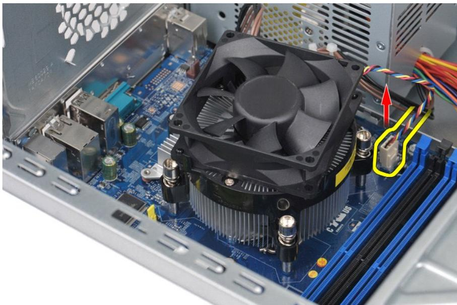
4. Desserrez les quatre vis imperdables qui fixent l'assemblage dissipateur de chaleur et ventilateur du processeur sur la carte système à l'aide d'un tournevis cruciforme.
