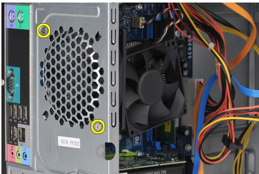
5. Faites glisser le ventilateur jusqu'à la partie centrale de l'ordinateur, puis retirez-le du châssis.
