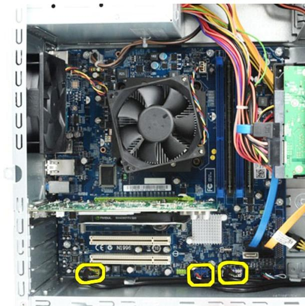
5. Retirez les câbles des guide-câbles situés le long de la paroi interne du châssis.
